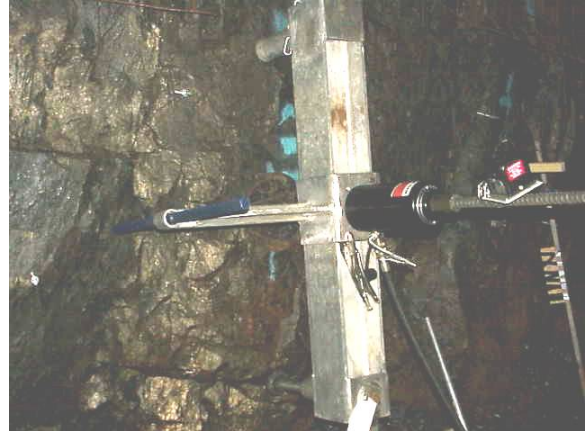
Figure 2: Inco Loading (Pulling) Frame
